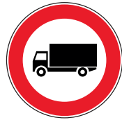
Fig. 60/b art. 117 Transito vietato per i veicoli di massa a pieno carico superiore a... ton.
