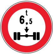
Fig. 69 art. 118 Transito vietato ai veicoli con massa per asse superiore a... ton.
